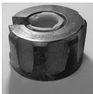
Рис. 2. Внешний вид отработавшего узла трения буровой коронки для бурения нефтяных скважин с подшипником скольжения
