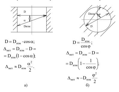
Так, при прямых измерениях внутреннего диаметра втулки средство измерений (например, наконечники нутромера) не может быть практически установлено так, чтобы воспринимать строго длину только того отрезка, который принят «по определению» за диаметр втулки, поскольку его практически невозможно установить строго в плоскости поперечного сечения и по диаметру (оно фактически устанавливается в плоскости, лишь близкой к плоскости поперечного сечения, и по хорде, лишь близкой к диаметру).
