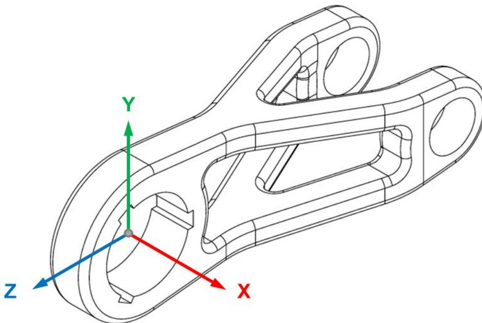
После выполнения построения необходимо измерить площадь поверхности, объем получившегося объекта, а также его моменты инерции относительно центра масс в предположении, что объект изготовлен из Алюминия 7075. Измерение должно быть выполнено с высокой точностью.
