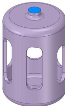
При этом на выделенное на картинке ниже отверстие действует равномерно распределенная сила, имеющая величину  $(0, 0, 600)$  Н в глобальной системе координат.
