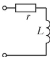
Для построения параллельной схемы замещения двухполюсника рассчитаем эквивалентную комплексную проводимость
