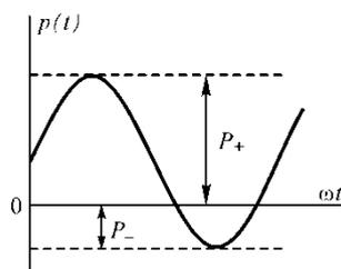
Определите активную ( $P$ ), реактивную ( $Q$ ) и полную мощности ( $S$ ), а также коэффициент мощности  $\lambda$ , с которым работает потребитель.  $P_+ = 500$  ВА,  $P_- = 100$  ВА
