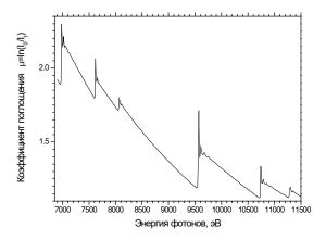
На рисунке представлен экспериментальный спектр рентгеновского поглощения для определенного образца. Предположите, сколько разных тяжелых элементов содержит данный образец? Ответ обоснуйте.
